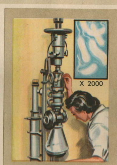
1930 - Le microscope électronique. A l'aide de cet instrument de recherche, construit vers 1930, on peut obtenir des agrandissements mille fois supérieurs à ceux des meilleurs microscopes optiques.
